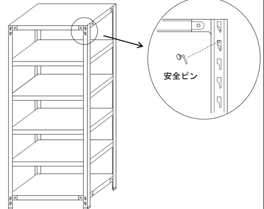
⑥全体のバランスをとり、ガセットプレート部分(上下前後8箇所)に安全ピンを差し込む。(上図参照) ※この時ピンが入りにくいようであれば支柱にガセットプレートが正しく差し込まれていないので、棚板のガセットプレート取付部分にキズが付かないよう当て物などを行い、木槌等で軽く叩いて入れてください。
