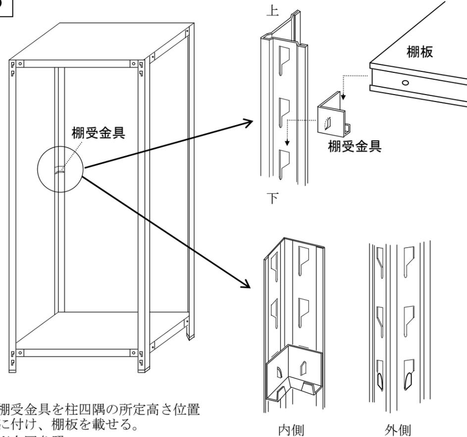
⑤棚受金具を柱四隅の所定高さ位置に付け、棚板を載せる。 ※右図参照
