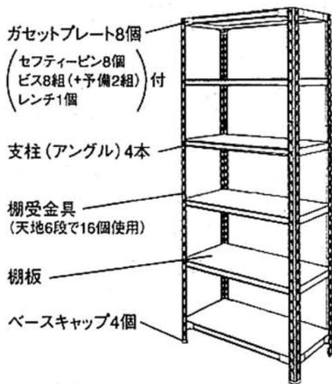
**1** 棚板コーナー部にガセットプレートをはめ、(刻印 R④、L④が間口方向)ビスで固定。四角に取付け、この棚板を2枚分(最上段・下段)組み立てる。
