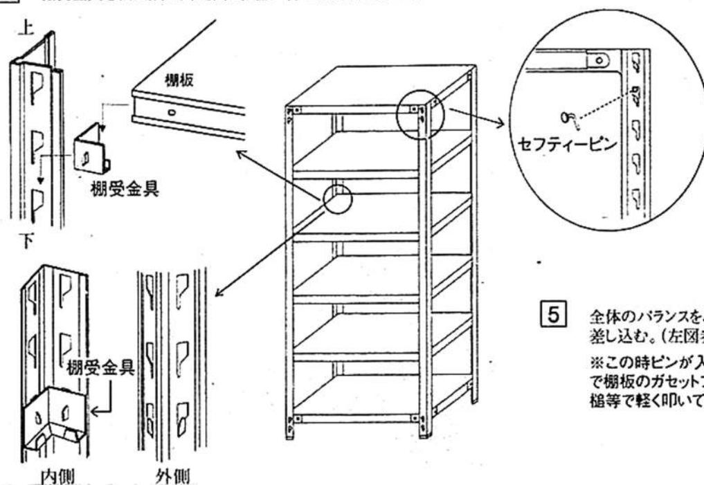
**5** 全体のバランスをとり、ガセットプレート部分(上下前後8箇所)にセフティーピンを差し込む。(左図参照)
