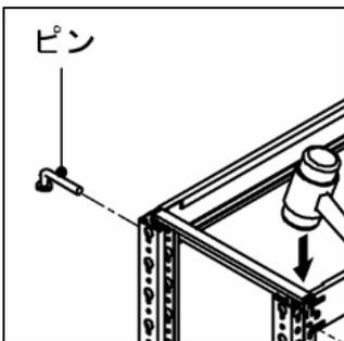
スチールラック本体組立説明書に「ロックピン (またはセーフティピン)」の差し込み作業がありますが、キャスターを取り付けた場合は、これを取り付けず、代わりに必ず付属のボルト・ナットを取り付けて下さい。また半年程度毎にゆるみがないかチェックしてください。
